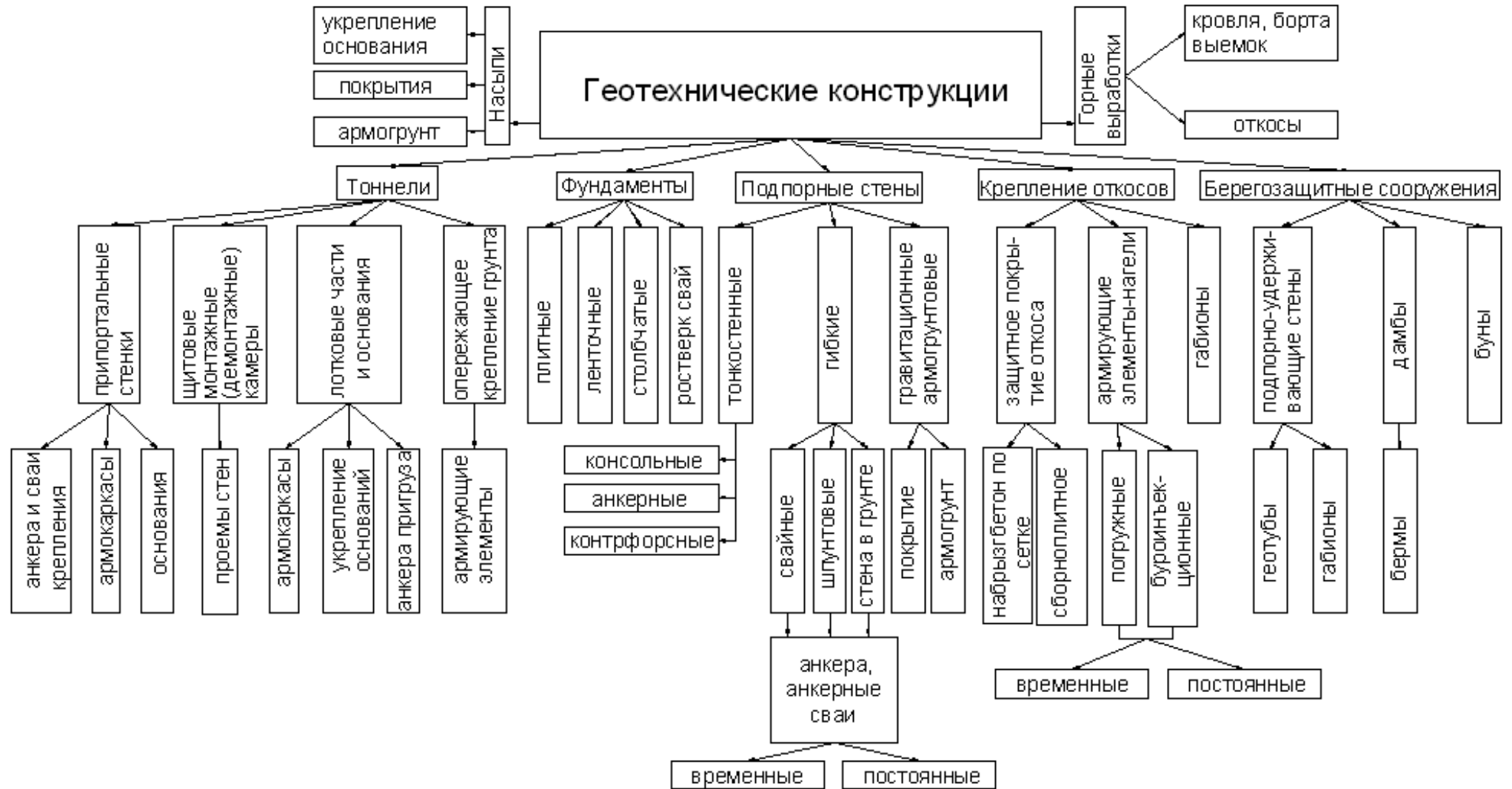
Рисунок 9.1 – Классификация геотехнических конструкций с возможным применением АНК
