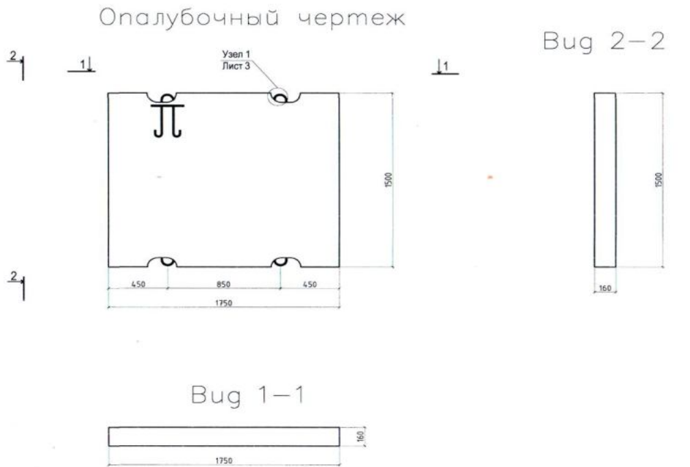
Рисунок 7.6 – Опалубочный чертеж дорожной плиты
