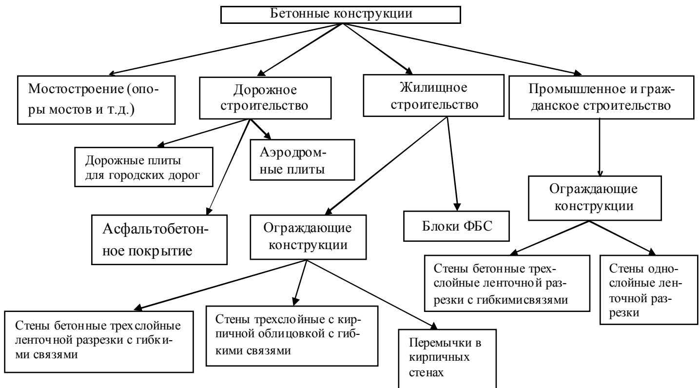
Рисунок 7.1 – Классификация бетонных конструкций с возможным применением АНК
